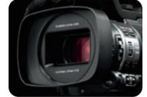
La distancia focal es de 3,7 – 37 mm. (equivalente a 39 – 390 mm. para una óptica de 35 mm.), aportando un buen compromiso entre rangos de zoom y gran angular. Para obtener un mejor gran angular, es posible extraer la visera y montar un convertor gran angular.
