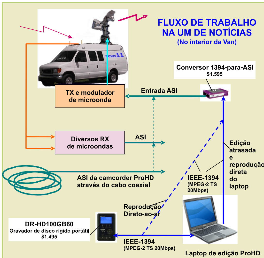
Fig. 9. O sistema ENG ProHD está no centro do “no ar ao vivo”, usando um cabo coaxial ou microondas sem fio até a UM, e da UM até o controle mestre da emissora por microondas. Além disso, o DR-HD100 e o laptop de edição permitem que as matérias editadas sejam transmitidas por microondas até o controle mestre da emissora para pôr diretamente no ar, ou para edição adicional nas ilhas de edição de notícias das emissoras de TV.
